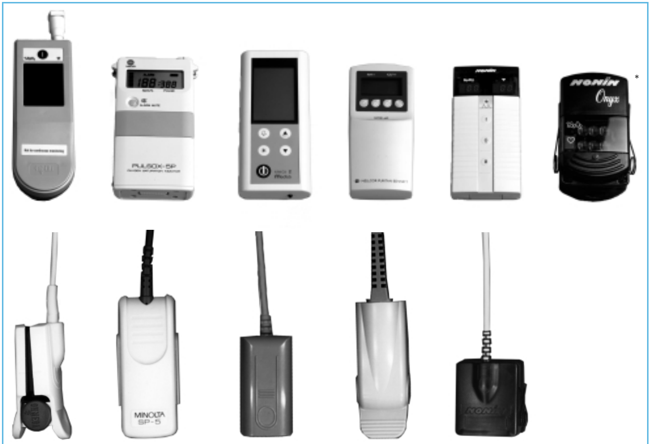
Abb. 1 Hand-Pulsoxymeter im Test. Oben, von links nach rechts: Biox 3770, Minolta Pulsox-5P, Nanox 2, NPB-40, Nonin 8500, Nonin Onyx 9500. Unten: Zugehörige Fingersensoren, vergrößert in Relation zu den Geräten.
