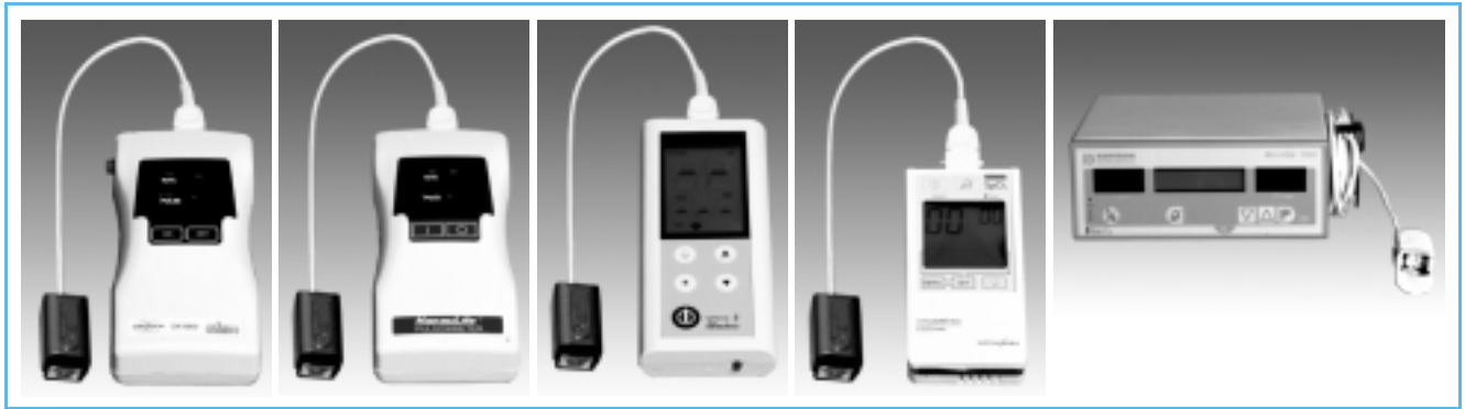
Abb. 1 Hand-Pulsoxymeter im Test (von links nach rechts): Bruker OX 1000 (BCI), Hanau Life (BCI), Nanox 2 (Medlab), Oxycount mini (Weinmann), jeweils mit den zugehörigen Sensoren. Zusätzlich im Test (ganz rechts) das Mobil-Pulsoxymeter Micro Sat 7850 (Kontron).
