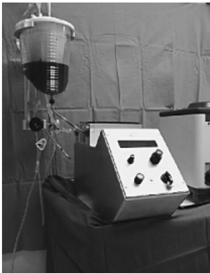
Abb. 1 Modellkreislauf aus Rollerpumpe und Kardiotomiereservoir zur Untersuchung des mechanischen Hämolyseverhaltens von Erythrozytensuspensionen (nach [43,46]).
