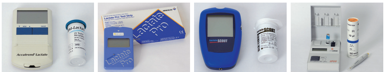
Abb. 1 Mobile Laktat-Messgeräte: alle Testgeräte, ganz rechts das Referenzgerät.
